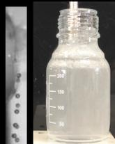
液体ポンプを使用せずに閉鎖空間内において**気泡径分布と個数密度を自在に制御**可能
